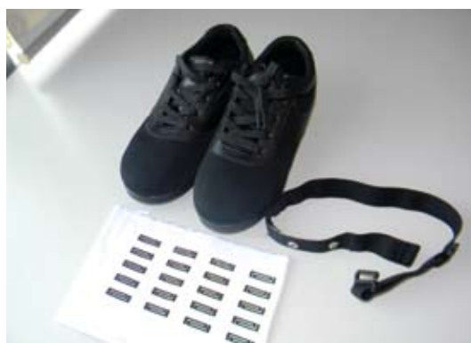
以紡織物做材料的壓力傳感器，可置於鞋墊之內。
