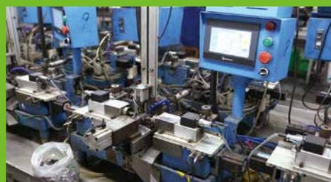
鑽孔自動化加工設備
