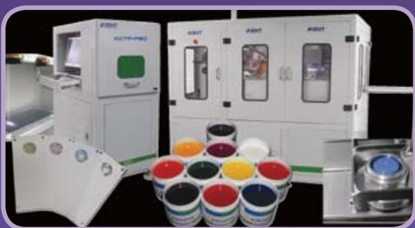
環保移印系統是一套融合多種創新設計、關注環境保護的生產系統。該系統包括專利密封油杯、激光蝕刻機及UV油墨工藝。密封油杯設計可節省油墨和開油水；激光蝕刻機代替舊式使用菲林和酸劑的化學蝕刻過程，直接標刻印刷板，配合CAD系統，保證印刷圖案定位精準無誤；UV油墨減少使用75%開油水，及達到快乾的效果。該系統同時可快速轉換印刷工作。該產品設計靈活，是一個既環保、經濟又高效的系統。
